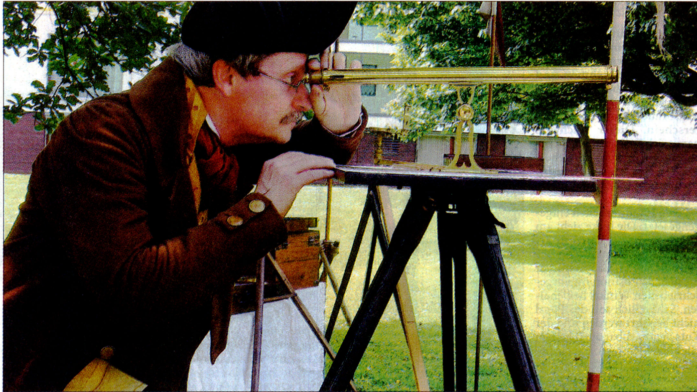
Die Hausecke im Visier: Dr. Martin Klöffler alias Hannes Klurfinkel wendet das Messtischverfahren an.
